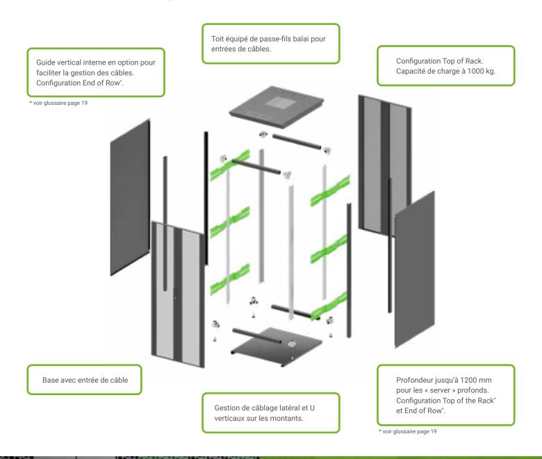
La gestion des flux d'air chaud et froid et la température interne est facilitée grâce aux portes perforées à 80% de nos baies **TM1000**.
